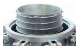
Die Suspension wird der SKS von oben, zentral zugeführt und durchströmt einen Spalt- oder Gewebefilterzylinder von innen
